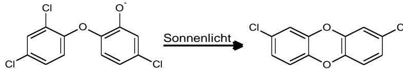
Abbildung 4-9: Umwandlung von Triclosan (pKa = 7,9) in 2,8-Dichlordibenzodioxin (2,8-DCDD). Zwischenschritte der Reaktion sind nicht dargestellt.
