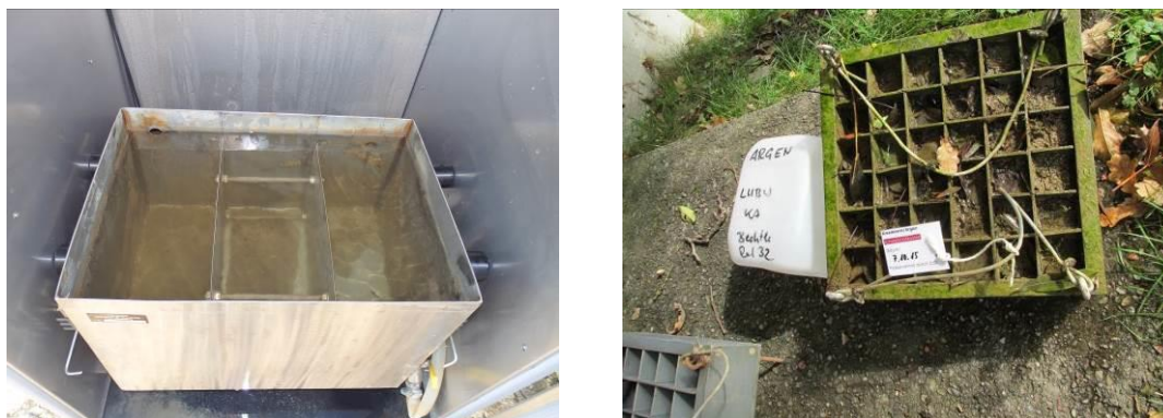
Abb. 3: Probenahme von Schwebstoff mit einer Schwebstofffalle bzw. mit einem Schwebstoff-sammelkasten (Quelle: Heike Robakowski, Landesanstalt für Umwelt Baden-Württemberg)
