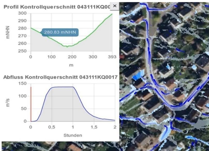
**Abbildung 34:** Beispiel der Starkregengefahrenkarte in der Web-Anwendung mit Kontrollquerschnitt eines Fließweges in der Gemeinde Eppelborn.
