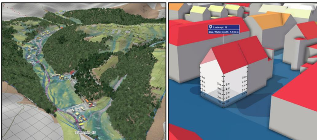
Abbildung 33: 3D-Ansichten einer Modellrechnung in der Modellierungs- und Visualisierungssoftware Visdom (links) und von Wasserständen an einem Gebäude (rechts). (Bildquelle: LfU RP).
